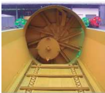
ESPARCIDOR DE TURBINA CON ROTOR DE CUCHILLA Y CUCHILLO RASPADOR.
