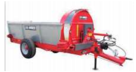
GALVANIZACIÓN EN CALIENTE DE PAREDES LATERALES Y PUERTA TRASERA
